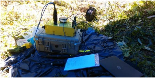
Gambar 2. Seismograf DAQlink III dan beberapa perlengkapannya.
