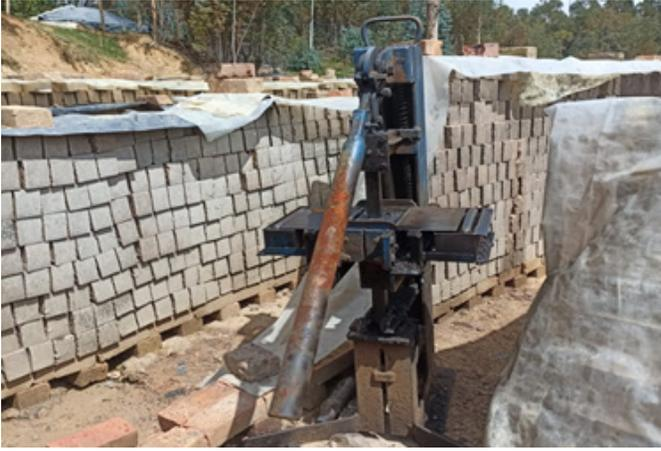
Fig. 1 Máquina prensadora de ladrillo
