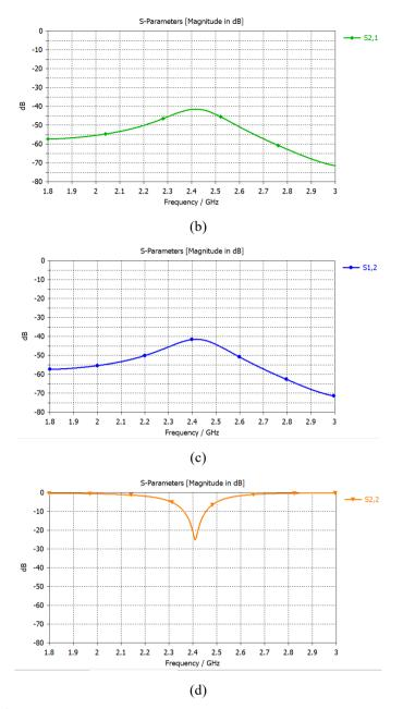
Fig. 3 - Plots for simulation of MIMO antenna (a) S11; (b) S21; (c) S12; (d) S22
