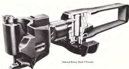
Рис. 6. Автосцепка National E-F с поворотным хвостовиком [16].
