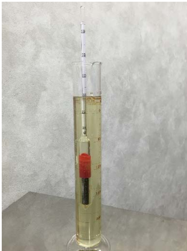
図 1.2 SPT による重水の作成 (密度 2.8g/mL)
