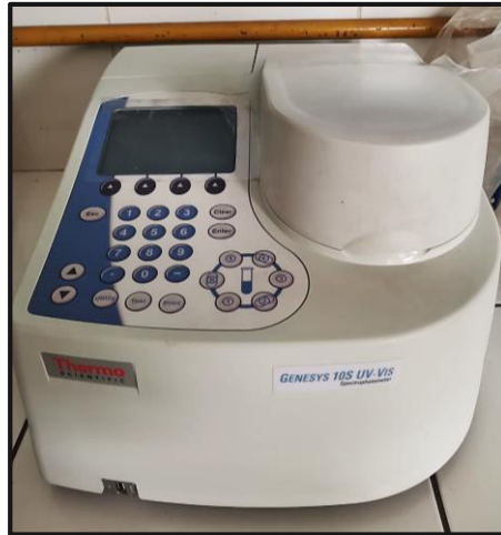
Figura 25. Espectrofotómetro UV-VIS. Marca: Thermo Scientific. Modelo: GENESYS 10S UV-Vis
