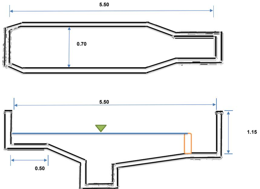
**DISEÑO DE TANQUE IMHOFF**
