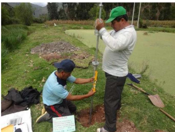
Se observa la penetración del suelo con instrumento PDL
