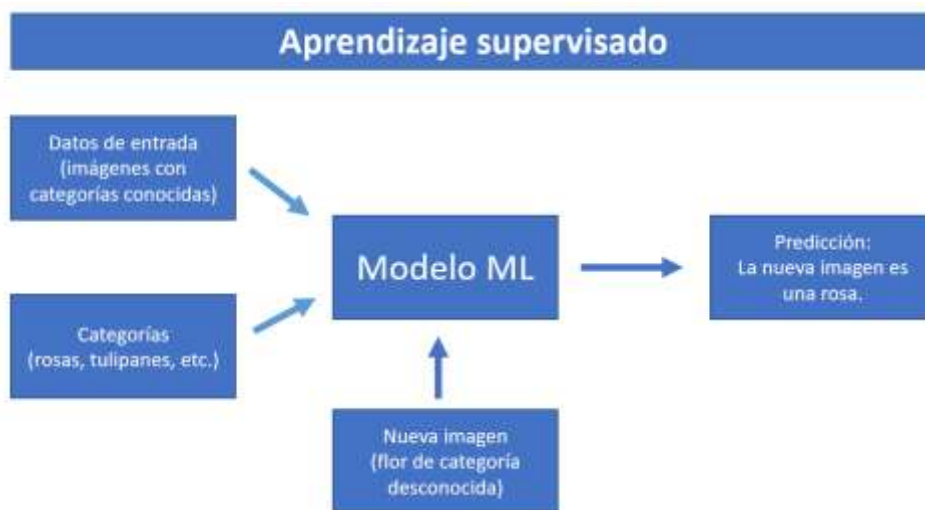
Figura 13. Esquema del proceso que ocurre durante el aprendizaje supervisado en problemas de clasificación.
