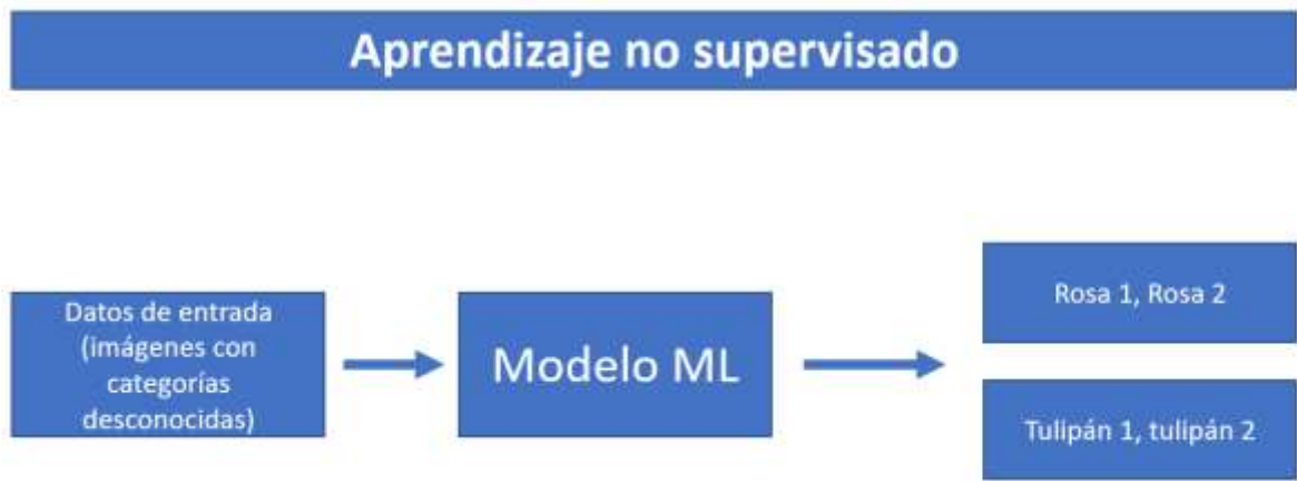
Figura 14. Esquema del proceso que ocurre durante el aprendizaje no supervisado en problemas de clasificación.
