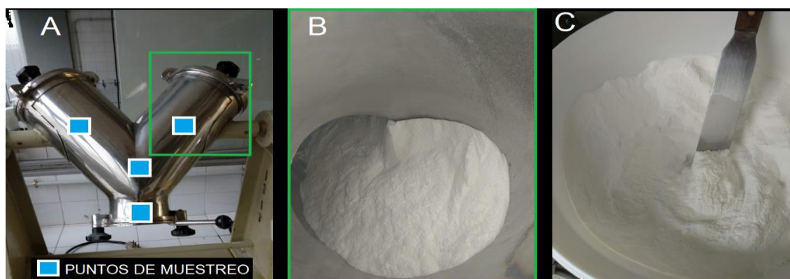
Figura IV.22. Puntos de muestreo mezcla «fórmula propuesta nº 13» (A), mezcla final en equipo mezclador (B) y detalle de la misma (C)
