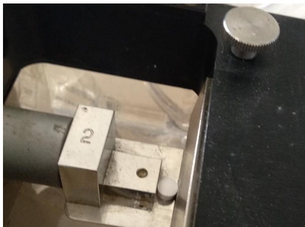
Figura IV.20. Detalle ensayo dureza con CBD-LH «fórmula propuesta nº 12»
