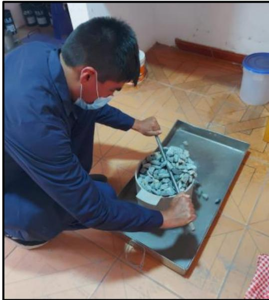
*Figura 16:* Enrasado del borde superior del molde
