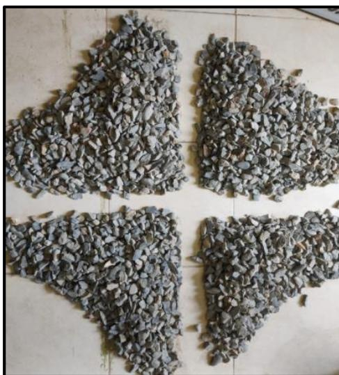
*Figura 13: Cuarteo de agregado grueso*
