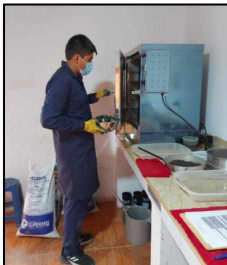
*Figura 26:* Colocado de muestra en horno
