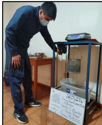
*Figura 28:* Peso de la muestra saturada superficialmente seca
