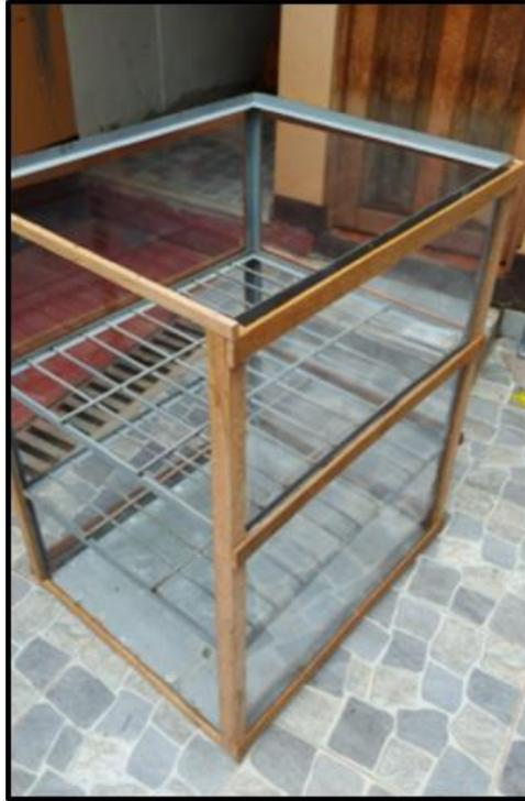
*Figura 43:* Cobertura con plástico doble transparente y sellado con perfiles de madera
