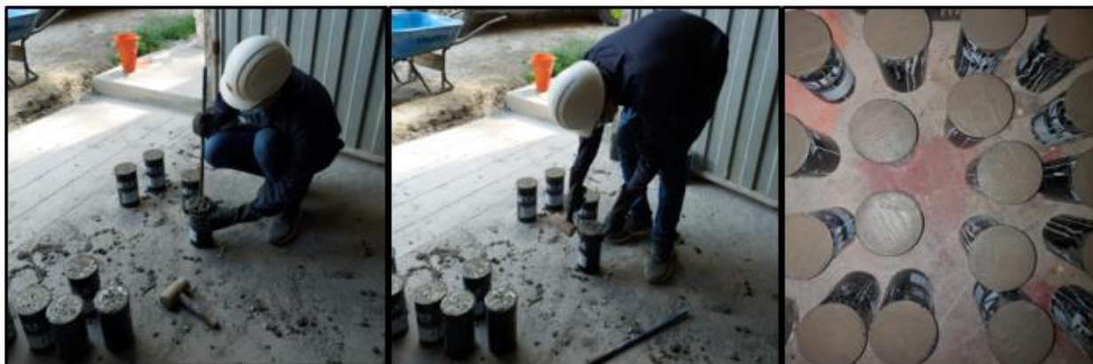
Figura 38: Proceso de elaboración de briquetas
