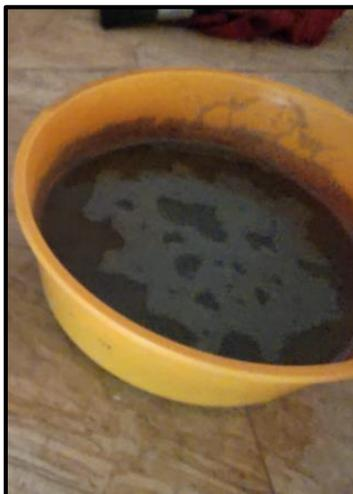
*Figura 21:* Saturación de muestra cubierta por agua en su totalidad
