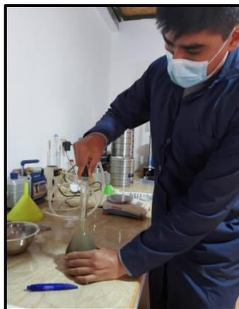
Figura 25: Extracción de aire del agregado con bomba vacíos
