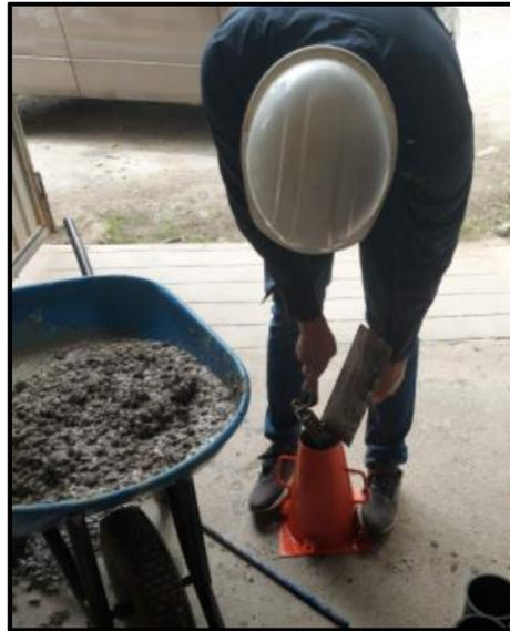
*Figura 39:* Colocado de mezcla en el cono de Abrams
