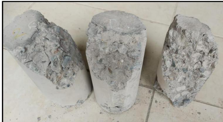
*Figura 46:* Tipos de fallas ocurridas posterior al ensayo de resistencia a la compresión
