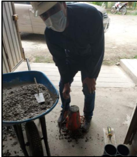
*Figura 40:* Enrasado de superficie del cono de abrams
