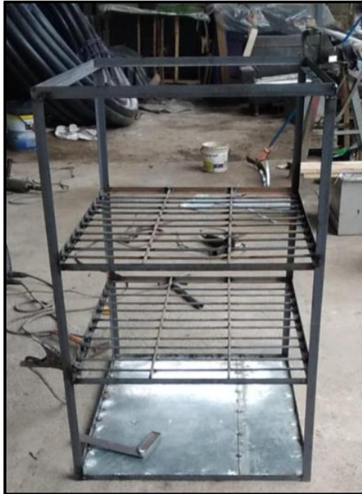
*Figura 42:* Estructura metálica de la cámara de carbonatación
