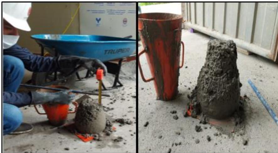
*Figura 41:* Medición del slump
