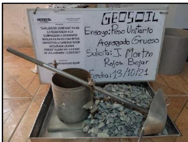
Figura 15: Equipos para la obtención de peso unitario
