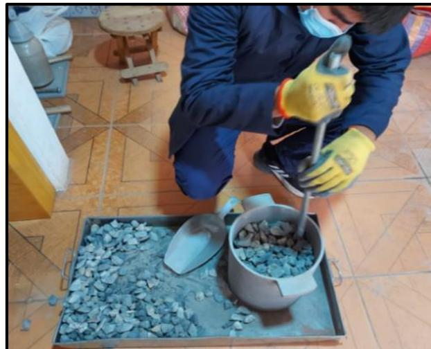
*Figura 19:* Compactado de material
