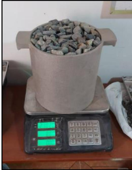
*Figura 20: Peso de muestra Compactada*
