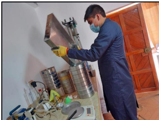
*Figura 12:* Tamizado de agregado fino
