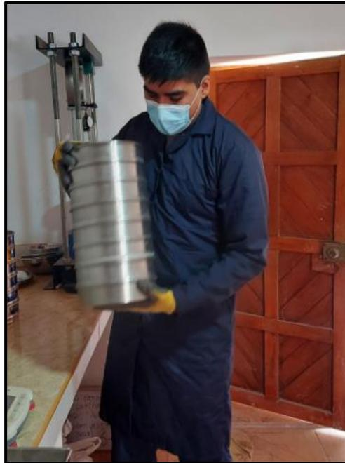
*Figura 14:* Granulometría mecánica de agregado grueso
