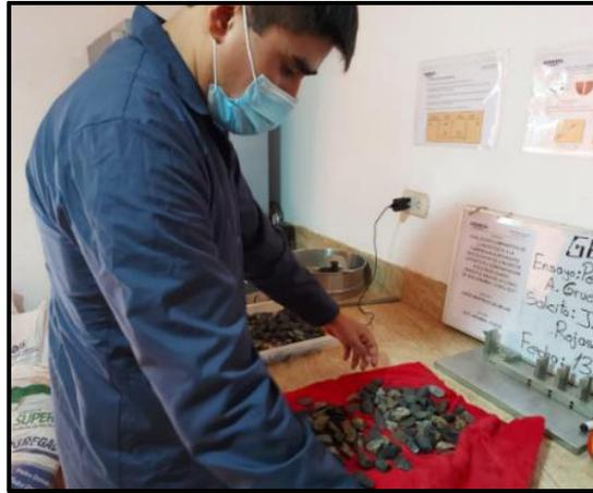
*Figura 27:* Secado superficial de muestra
