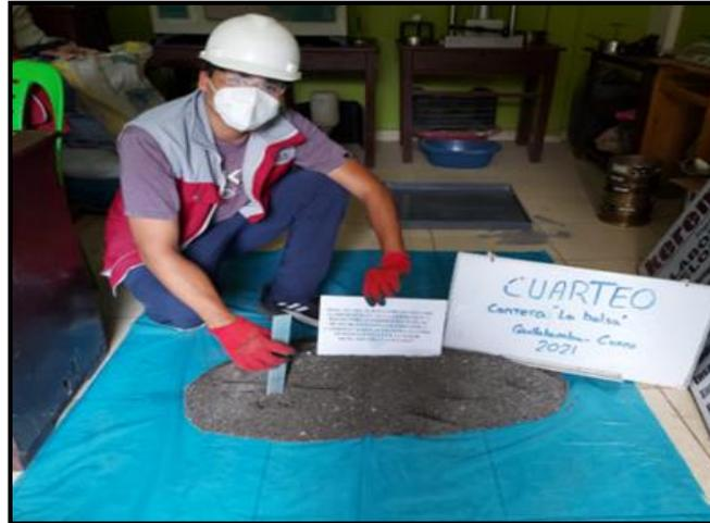
*Figura 10:* Ensayo de cuarteo para el agregado fino
