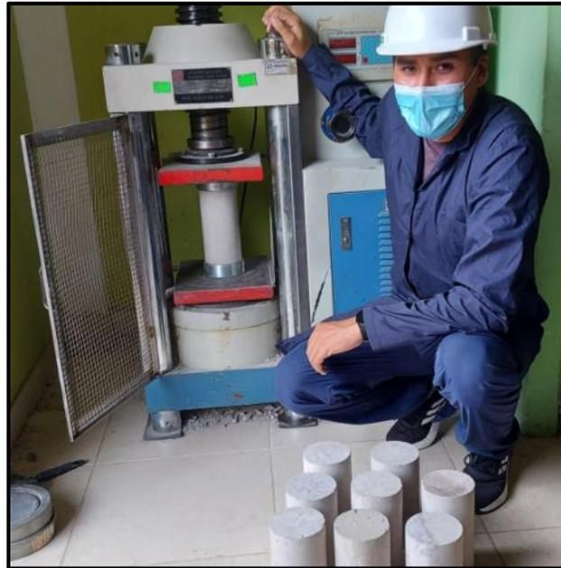
*Figura 45:* Ensayo de resistencia a la compresión
