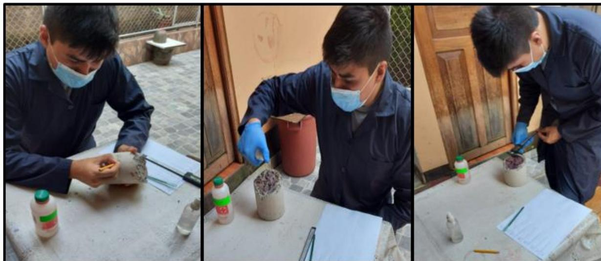
*Figura 48:* Proceso de ensayo para la obtención de la penetración de carbonatación artificial. Después de unos segundos se observa la reacción y el cambio de coloración. Se procede a medir con el vernier la profundidad del frente de carbonatación y se registra según la ficha de recolección de datos desarrollada.
