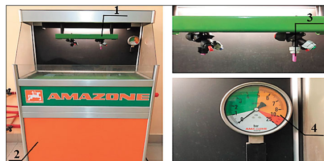
Рис. 3. Испытательный стенд для исследования распылителей: 1 – штанга; 2 – корпус стенда; 3 – исследуемые распылители; 4 – манометр для регулирования давления
