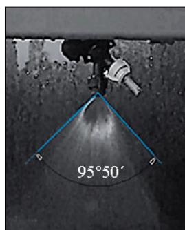
Рис. 4. Измерение угла распыла с применением программы Компас-3D
