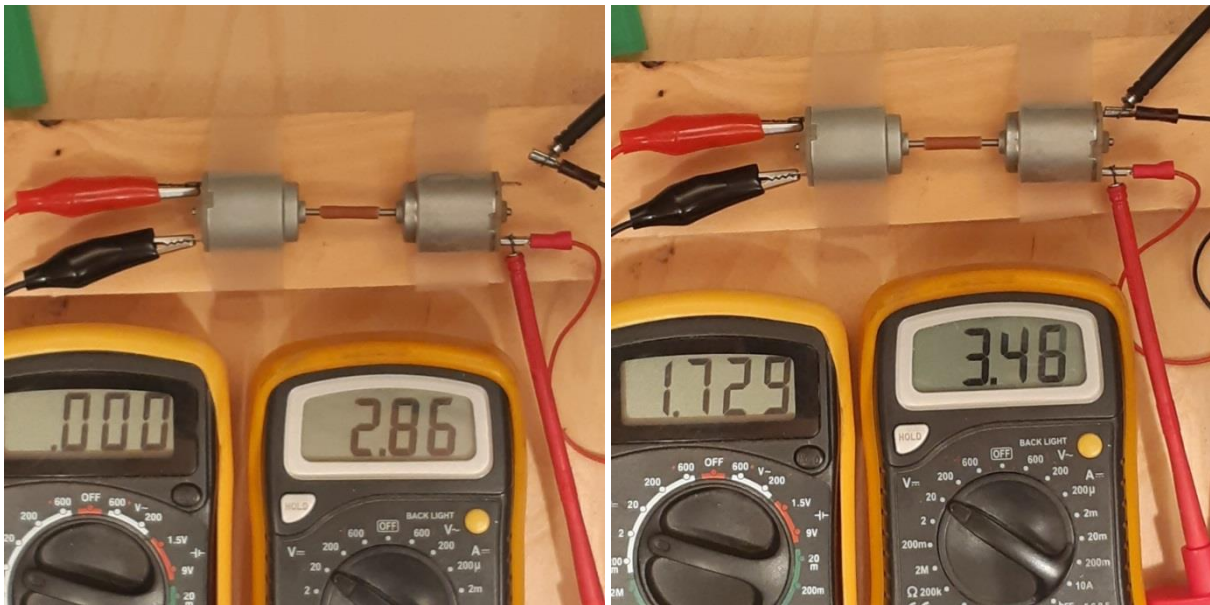
Kuva 37. Virtalähteen lähdejännite ensiömoottorille.
