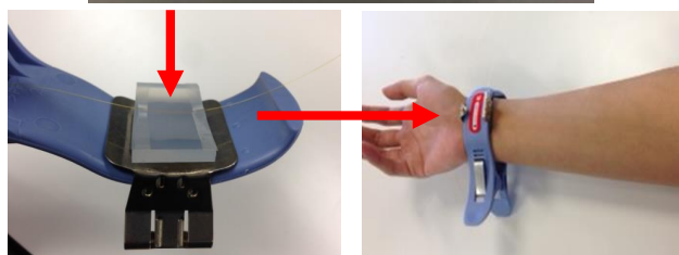
Fig. 4.1 クリップを用いた脈波測定の詳細
