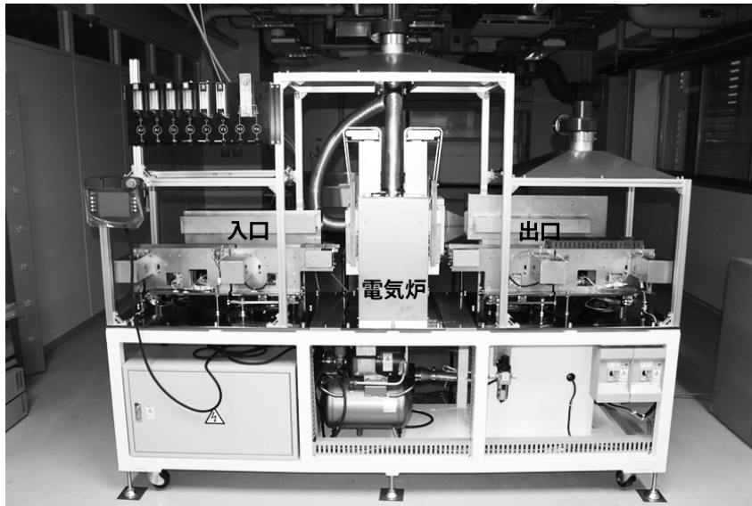
図 9 FRP の連続分解装置
