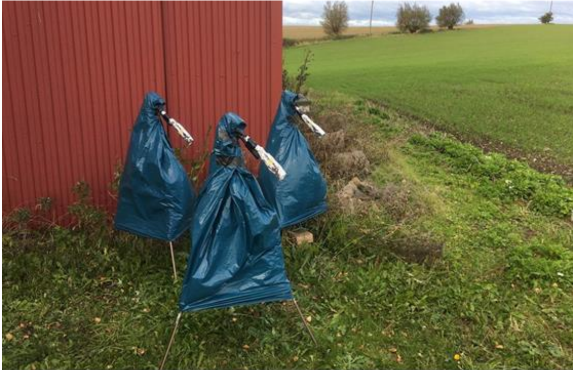
Figur 2. Tre luftprovtagningsutrustningar monterade på kamerastativ och omslutna av skyddande plasthölje. Foto: Glenn Svensson.
