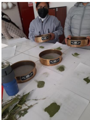
Leyenda: Se muestra la imagen de la forma de TAMIZAR el polvo de la hoja de “mango” Fuente: Elaboración propia enero, 2022.
