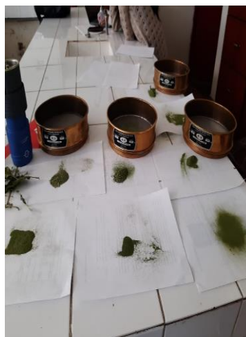
Leyenda: Se muestra la imagen de la forma de TAMIZAR el polvo de la hoja de “mango” Fuente: Elaboración propia enero, 2022.
