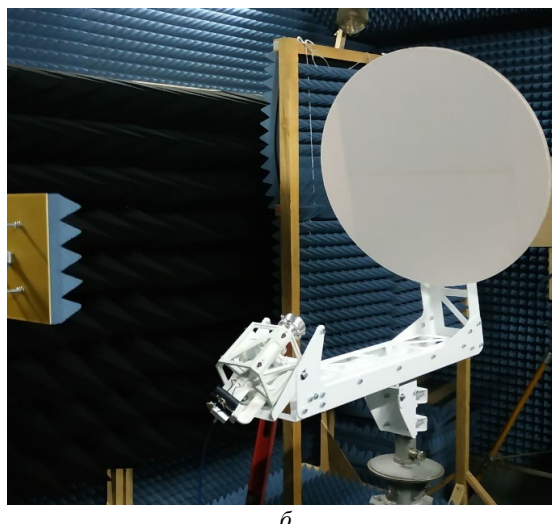
Рис. 6. Макет двухдиапазонной ОАР: а – чертеж; б – ОАР во время измерений в безэховой камере
