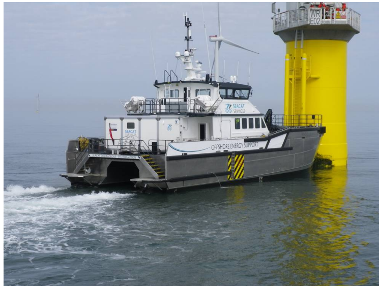
Figura F0.4: Catamarán de apoyo a aerogeneradores en contacto con torre offshore. Fuente: marinelink.com
