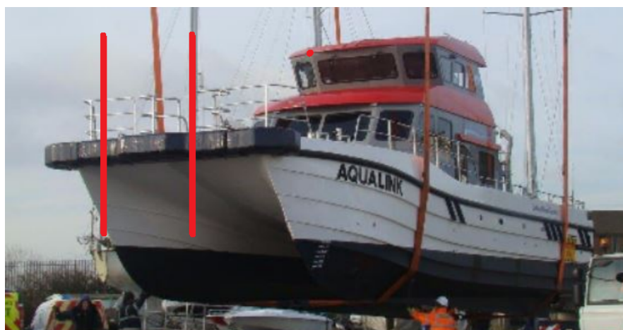
Figura F0.4: Defensa de proa de un catamarán de apoyo a aerogeneradores representando en rojo la ubicación de contacto con los refuerzos verticales de la torre offshore.. Fuente: Elaboración propia sobre foto de Ocean3.
