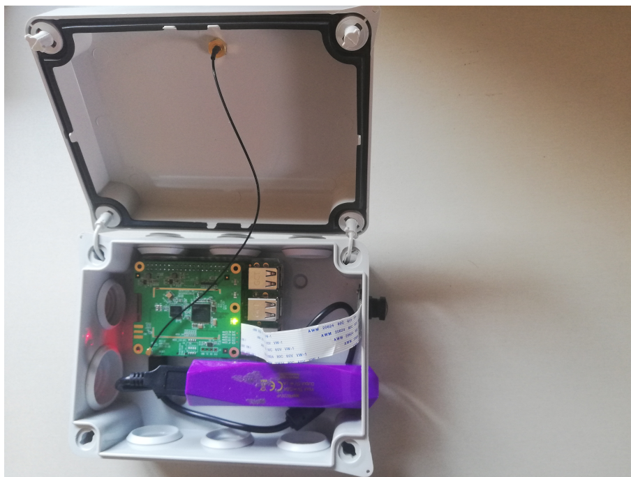
Figura 17: Prototip del sensor amb la càmera
