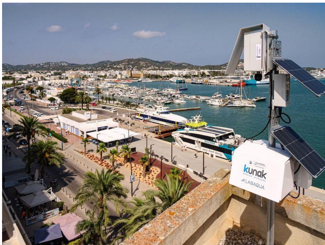
Figura 45: Dispositivo de medición de contaminación en tiempo real en el entorno del Puerto de Ibiza. Fuente: Portal web de Kunak.
