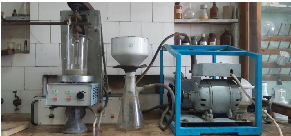
Рис. 1. Схема экспериментальной установки по растворению концентрата в технической фосфорной кислоте
