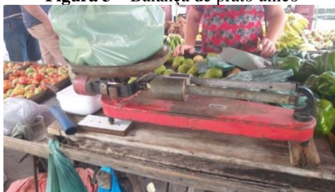
Figura 3 – Balança de prato único
