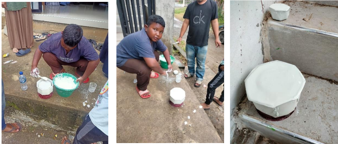
Gambar 6. Pencetakan campuran semen dan limbah kaca
