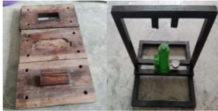
Gambar 1. Alat cetak dan tekan kamps rem
