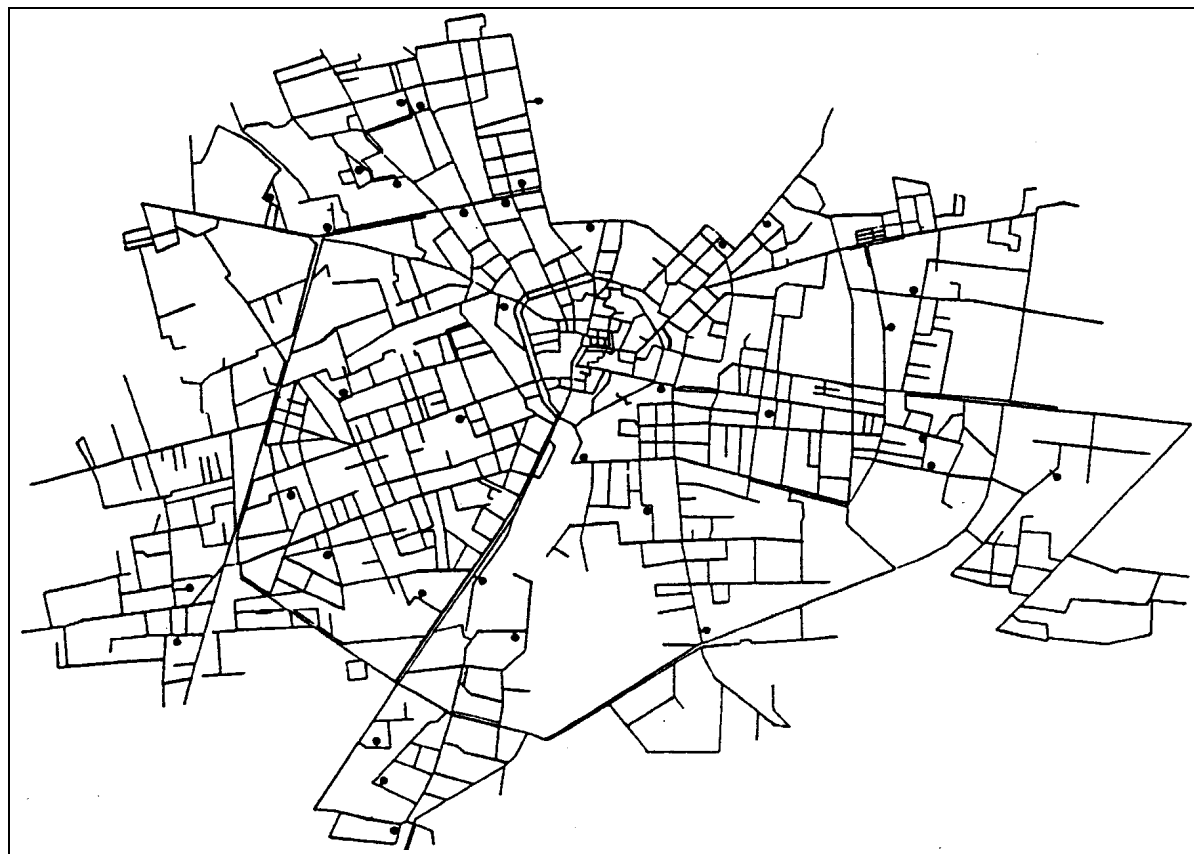
Figura 6.1: Schema della rete di distribuzione idrica di Monza
