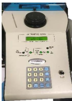
Figure 3.3-2 : Pycnomètre à hélium
