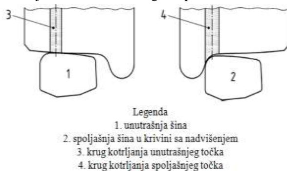
Slika 7 – Asimetrično reprofilisanje u krivinama malih radijusa za smanjenje habanja
