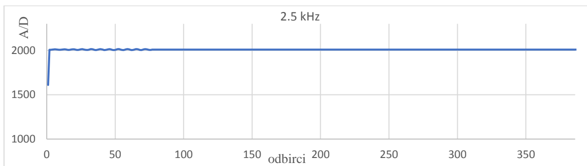
Slika 8-48. Rezultat odziva na četvrtke amplitude 1.5 V i učestanosti 2.5 kHz
