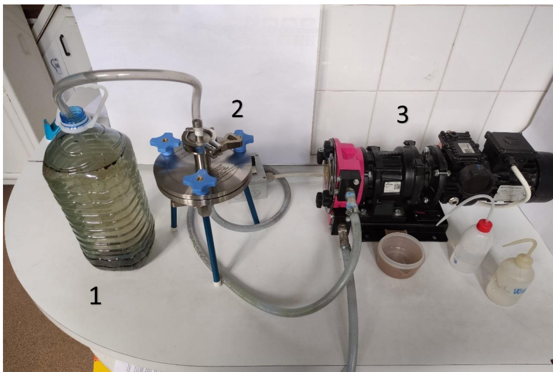
Slika 3.2. Prikaz postavke aparature za filtraciju vode; 1- Uzorak vode, 2- Držač za filter sa filterom plasiranim unutra, 3- Peristaltička pumpa
