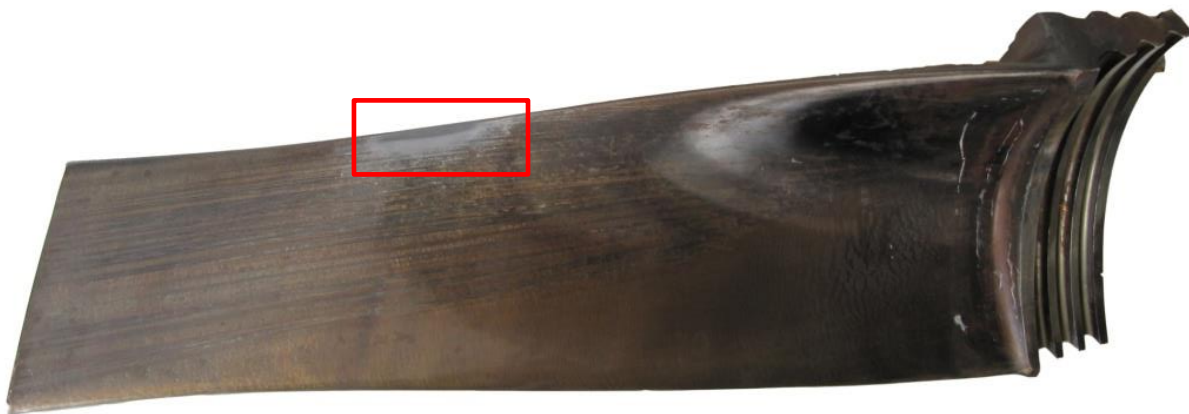
Obr. 1: Poškozená lopatka NT dílu turbogenerátoru JE s vyznačenou oblastí výskytu indikací
