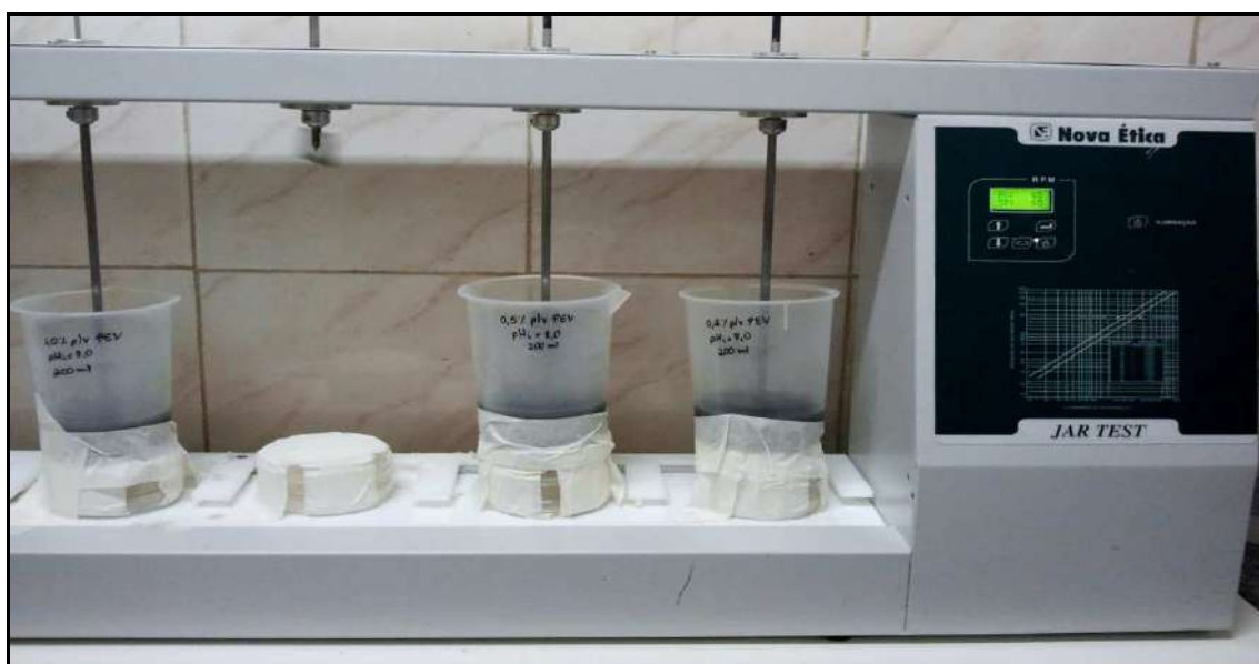
Figura 3.2: Foto do ensaio de hidrólise realizado em sala climatizada.
