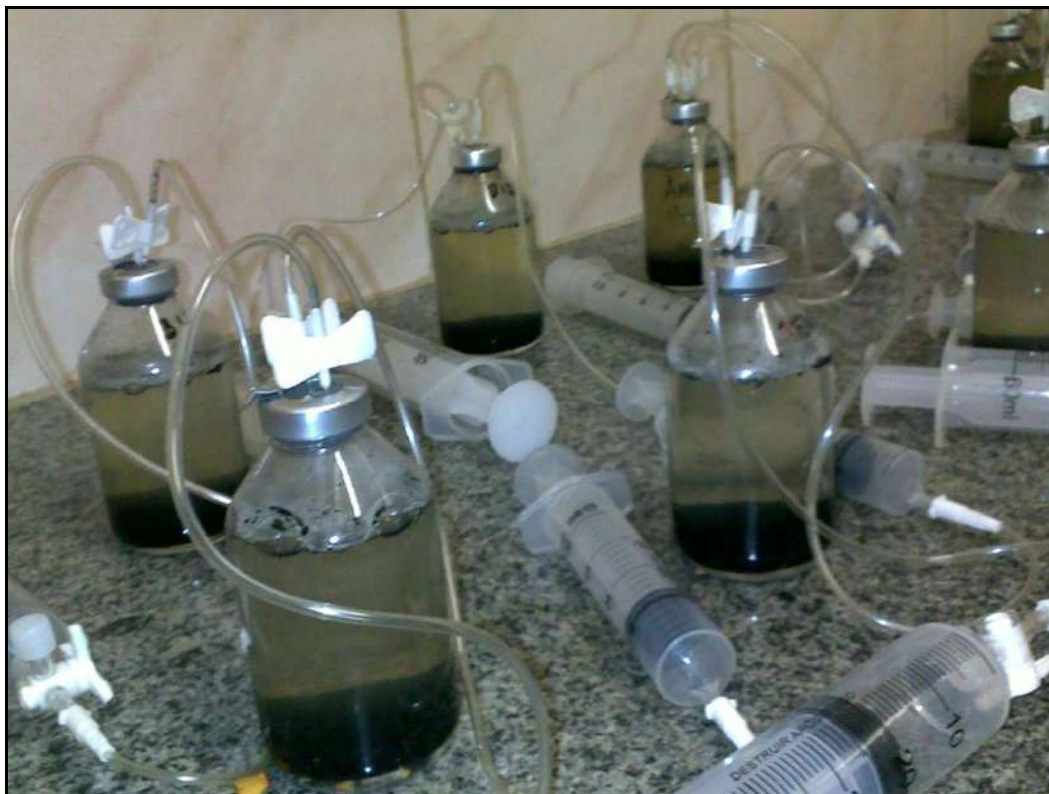
Figura 3.3 – Foto dos ensaios de biodegradabilidade em andamento.
