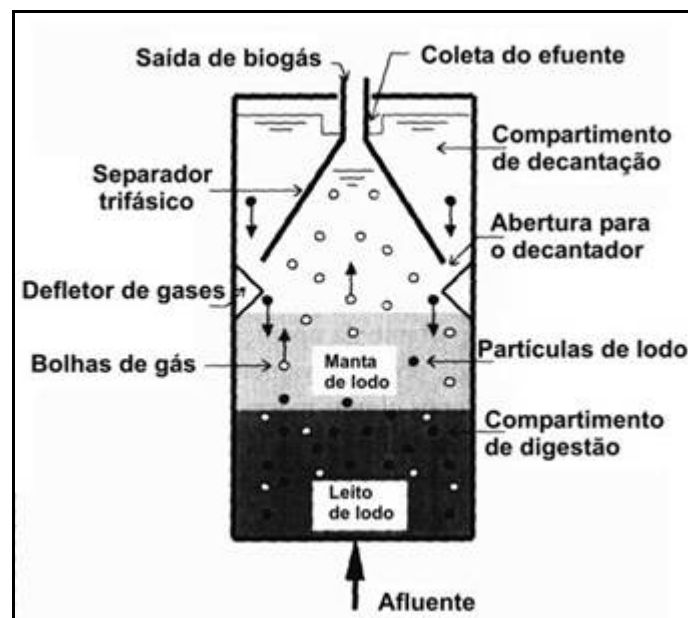
Figura 2.5: Desenho esquemático de um reator UASB. Fonte: O2 Engenharia, 2011.
