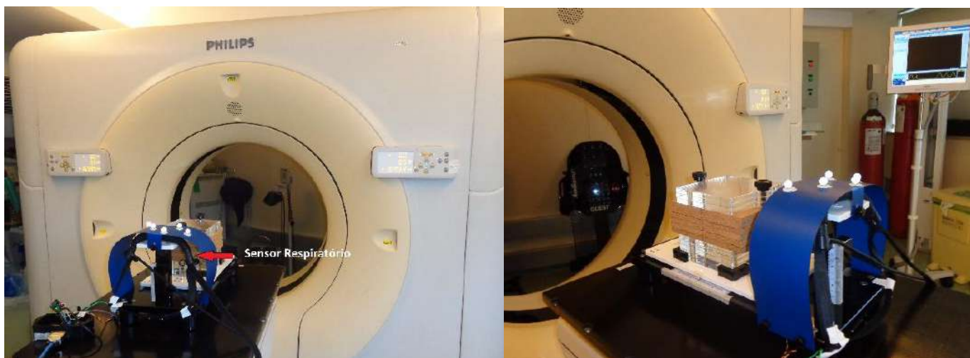
Figura 23: Tomografia Computadorizada 4DCT do Fantoma respiratório.
