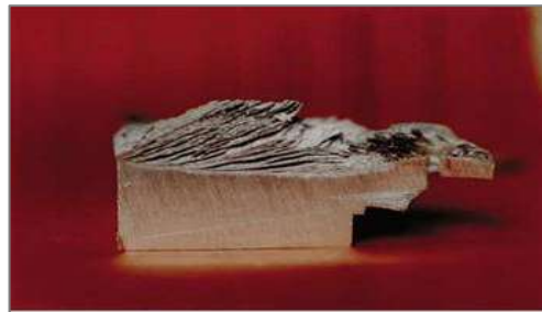
Figura II.8 - Peça de alumínio oxidada por esfoliação (GENTIL, 2007).
