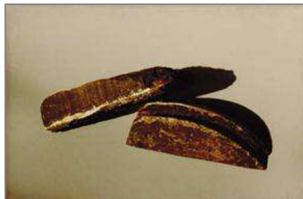
Figura II.9 - Corrosão grafítica em ferro fundido cinzento (GENTIL, 2007).
