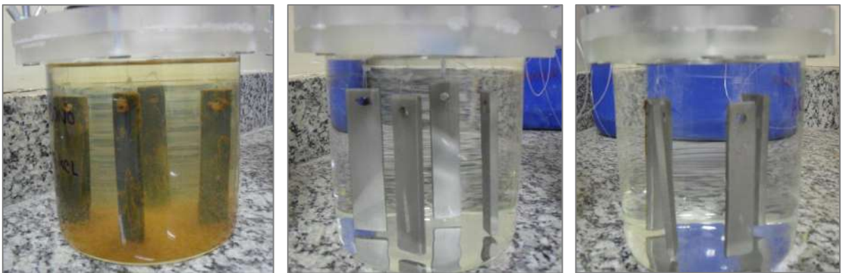
Figura III.23 - Células com corpos de prova de aço carbono, aço inoxidável 316L e aço inoxidável 304L (da esquerda para a direita). Registrada após 5 dias de contato.
