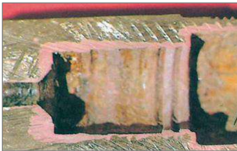
Figura II.10 - Peça de latão sofrendo dezincificação. Partes avermelhadas indicam consumo de zinco e presença de cobre (GENTIL, 2007).
