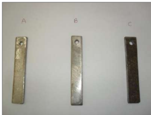
Figura III.20 – Corpos de prova antes e após o jateamento. A letra “A” escrita acima do corpo de prova indica que o mesmo é feito de aço inoxidável 304L, enquanto que a letra “B” indica o aço inoxidável 316L e a letra “C” indica que o material é de aço carbono.
