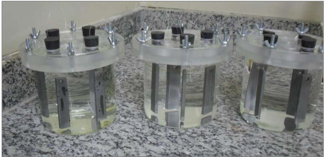
Figura III.22 – Células com corpos de prova de aço carbono, aço inoxidável 316L e aço inoxidável 304L (da esquerda para a direita). Registrada após 2 horas de contato.
