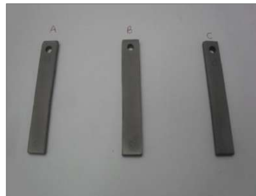
Figura III.20 – Corpos de prova antes e após o jateamento. A letra “A” escrita acima do corpo de prova indica que o mesmo é feito de aço inoxidável 304L, enquanto que a letra “B” indica o aço inoxidável 316L e a letra “C” indica que o material é de aço carbono.
