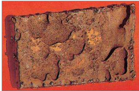
Figura II.2 – Corrosão em placas em chapa de aço-carbono encostado em tanque (GENTIL, 2007).
