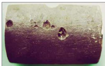
Figura II.3 Corrosão Alveolar em tubo (GENTIL, 2007).
