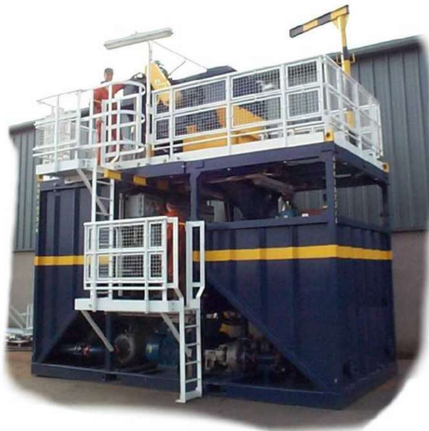
Figura 7.8 - Foto de uma unidade Slurrification já operando em plataforma.
