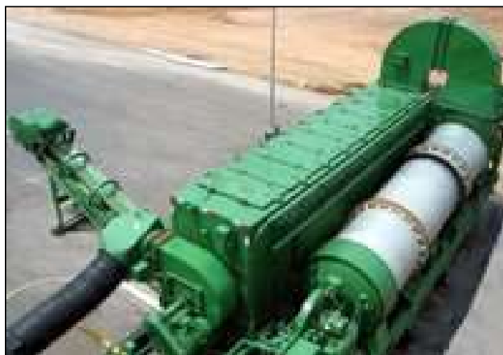
Figura 6.6 - Unidade de dessorção térmica. Fonte: Essencis Soluções Ambientais, 2012
