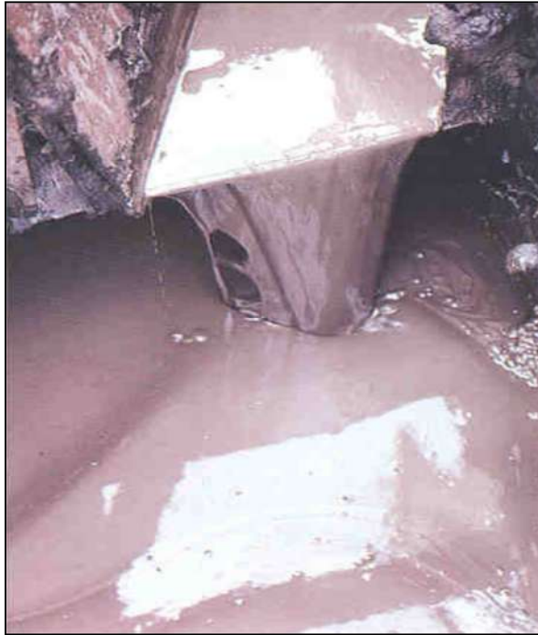
Figura 4.1 - Fluido de perfuração proveniente do sistema de tratamento de solidos.
