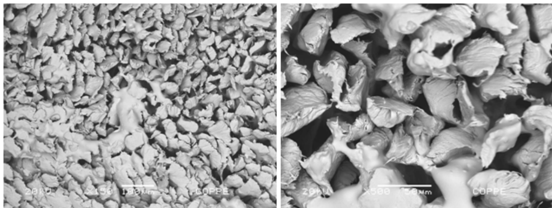
Figura 24 - MEV do laminado de Urethan CP 9221 + 5% argila + fibras, nos aumentos de 150x e 500x.
