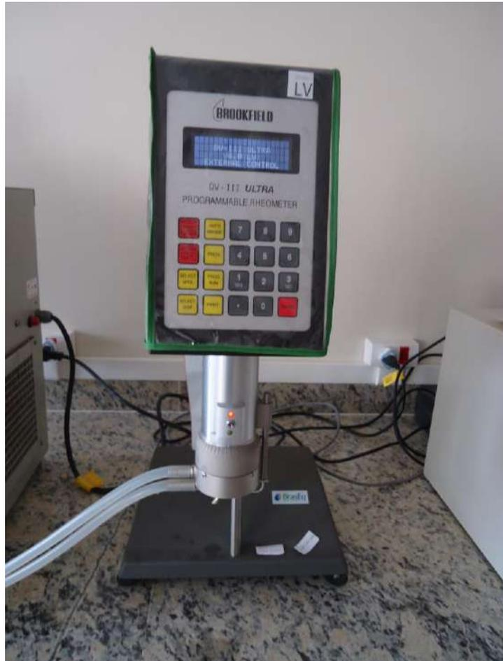
Figura 3.3: Reômetro utilizado no experimento, Brookfield modelo DV-III Ultra.
