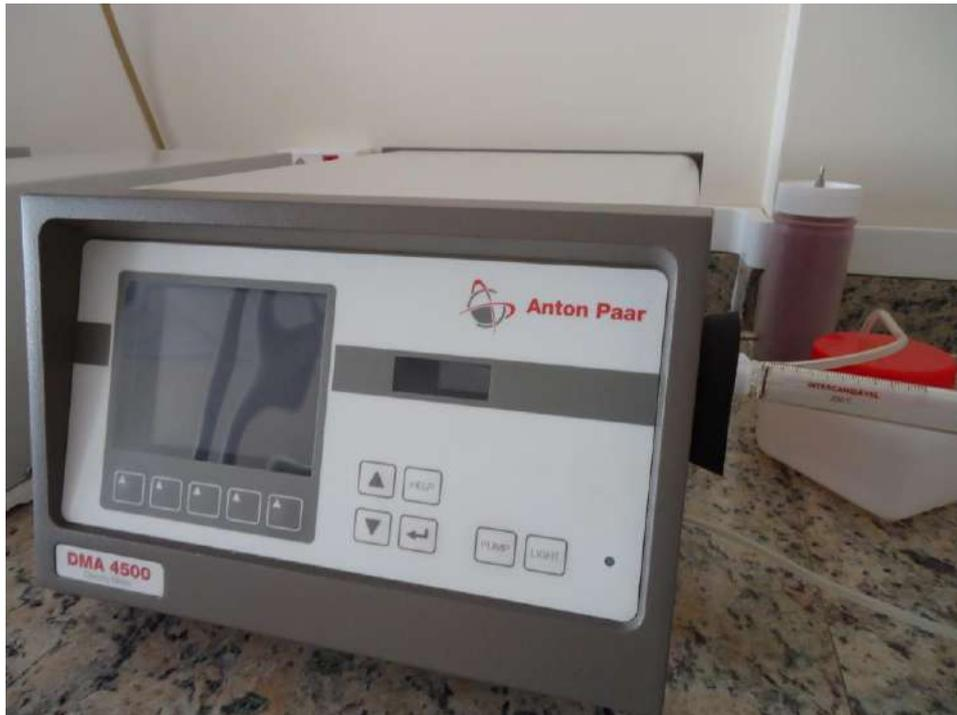
Figura 3.1: Densímetro utilizado no experimento, Anton Paar modelo 4500.
