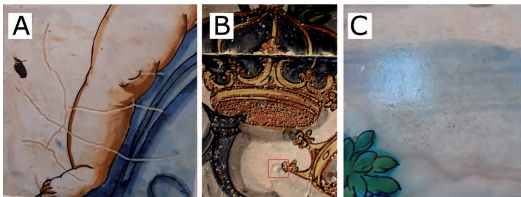
Fig. 14. Diferentes patologías: A-Grietas previo esmaltado. B- Burbujeados y rehundidos (en rojo). C- Moteados del esmalte blanco. Foto: Lucía Rueda Quero.
