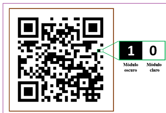
FIGURA 4. EJEMPLO DE UN MÓDULO OSCURO Y UNO CLARO
