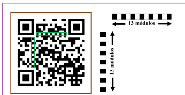
FIGURA 7. CÓDIGO QR CON UNA MATRIZ DE 29 POR 29 MÓDULOS CON DOS PATRONES DE TEMPORIZACIÓN DE 13 MÓDULOS CADA UNO (RECTÁNGULO VERDE)
