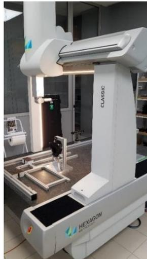
Figura 23- CMM (Máquina de medição de coordenadas).
