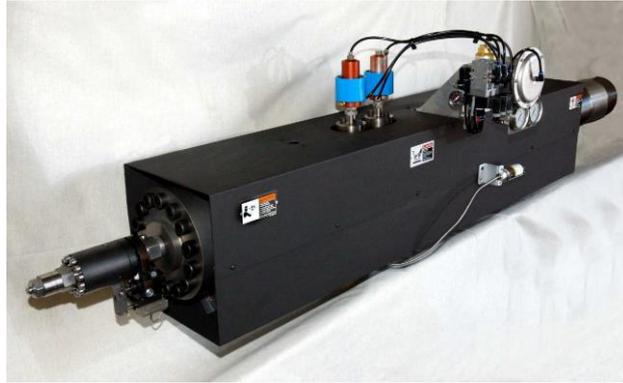
Figura 7- Módulo de injeção próprio do MuCell [17].
