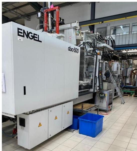
Figura 22- Máquina de injeção
