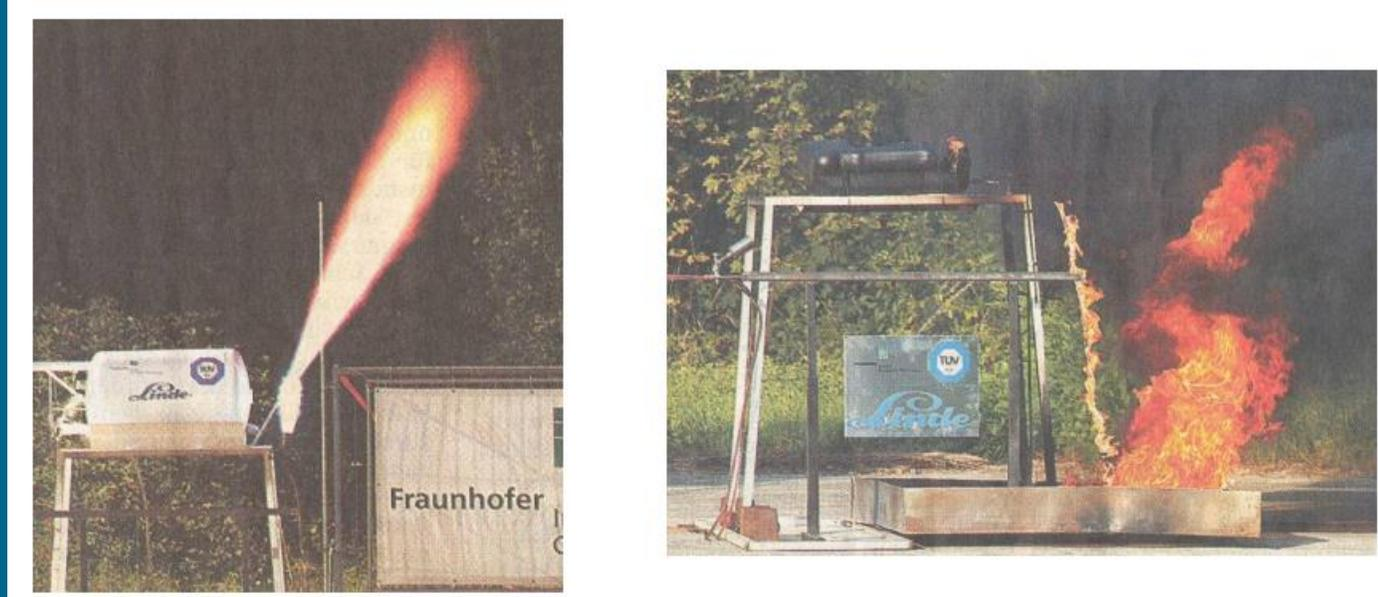
Wasserstoffflamme nach Leckage (links) und Benzinflamme nach Leckage (rechts); Quelle: VDI Nachrichten 24.10.2003
