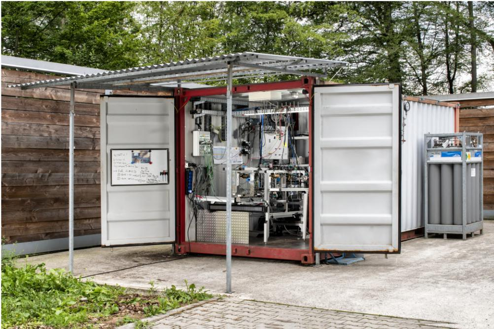
ABBILDUNG 3.2.: Testcontainer mit Prüfstand für grüne Treibstoffe auf dem Testfeld M11.5 aus [12]
