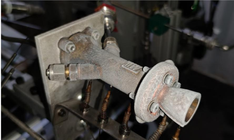
ABBILDUNG 3.1.: Versuchsbrennkammer nach einem Kaltgasversuch mit Stickstoff
