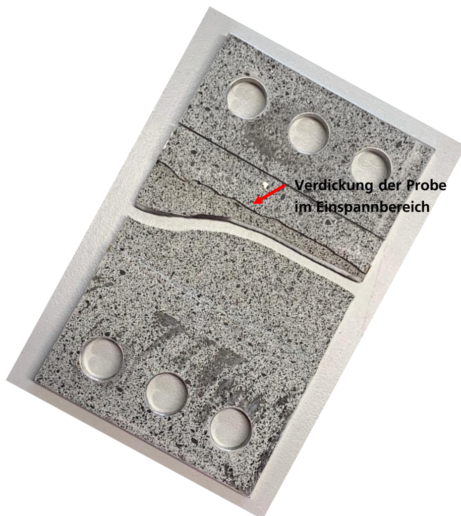
Abbildung 2-55: Bruchverlauf der 30°-Probe (90x145mm)
