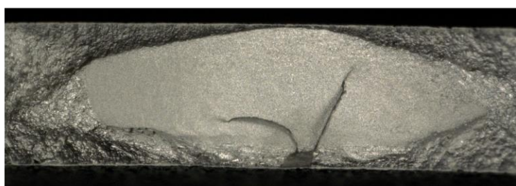
Abbildung 2-37: Bruchflächen der LOP-45° Proben entsprechend den DIC-Bildern in Abbildung 2-33.
