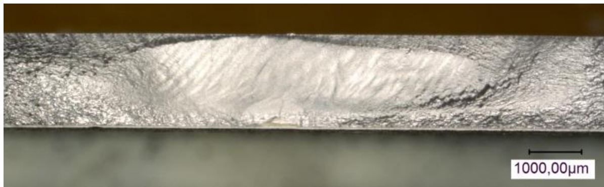
Abbildung 2-56: Bruchbild mit Rissentstehung
