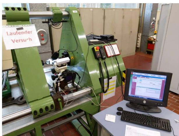
Abbildung 2-40: Aufbau Ermüdungsversuch: a) Maschinen-Übersicht mit horizontaler Probeneinspannung, b) Eingespannte Probe in der Bildmitte, dahinter die Kamera für die DIC-Aufnahmen mit Lichtquelle darüber
