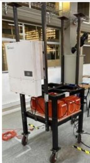
**9.5.2.2** *Inversor Off Grid.* El inversor se encarga de transformar la corriente de entrada en corriente alterna a 110v, para utilizar energía convencional. Es marca comercial Growatt SPH6000TL BL-US. Dicho inversor tiene capacidad de trabajar con una potencia máxima de 6000 kW (figura 27).
