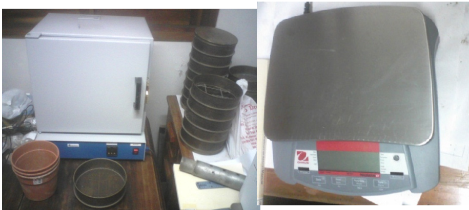
Figura 5. Izq. Equipo utilizado para la calibración de los sensores: Horno eléctrico, recipientes de plástico, tamices y proctor. Der. Balanza con precisión de 0,5 gramos
