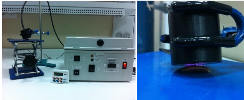
Resim 3.6. Plazma düzeneği ve plazma uygulanan bir örnek
