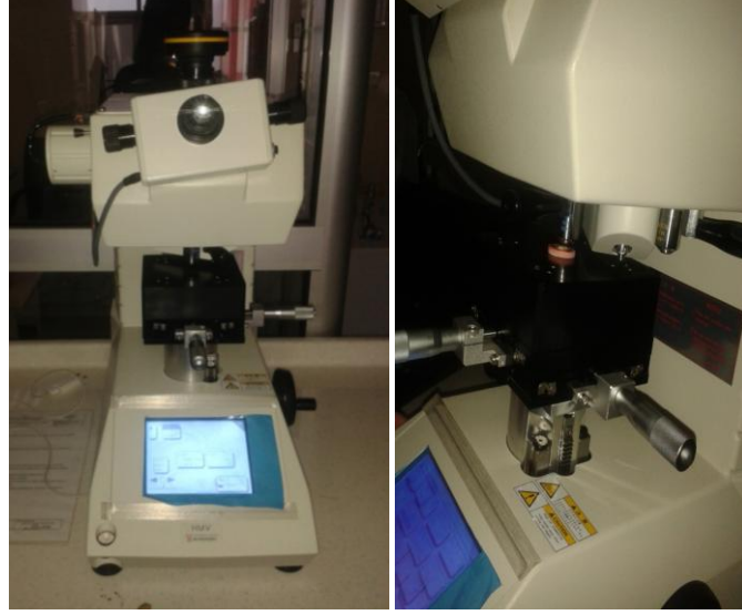
Resim 3.11. Mikrosertlik cihazı ve ölçüm işlemi yapılan bir örnek
