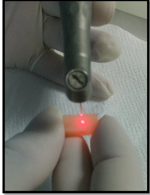
Resim 8: Er:YAG Lazerin örneklere uygulanması
