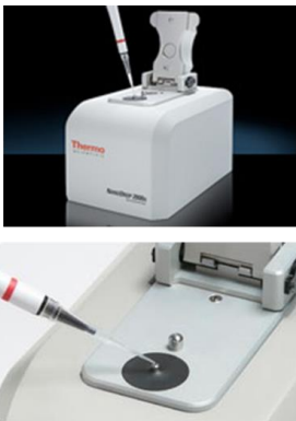
Şekil 5.3 Nanodrop cihazına DNA'nın yüklenmesi ve sonuç analizi
