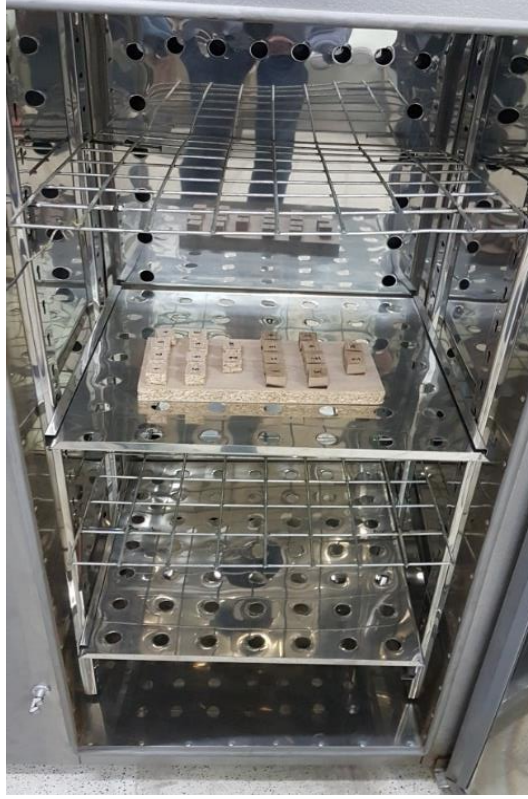
Şekil 3.26 : Numunelerin kurumaya bırakılması [Foto; Ongan, 2019].
