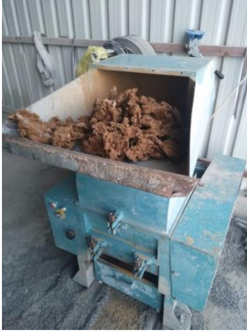
Şekil 3.19 : Extruderden elde edilen OPK ve kırımından sonra pelletler [Foto; Ongan, 2019].
