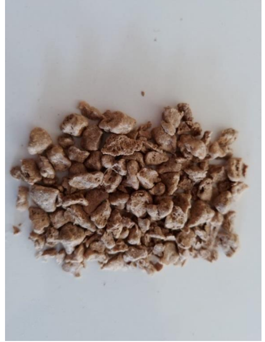
Şekil 3.19 : Extruderden elde edilen OPK ve kırımından sonra pelletler [Foto; Ongan, 2019].
