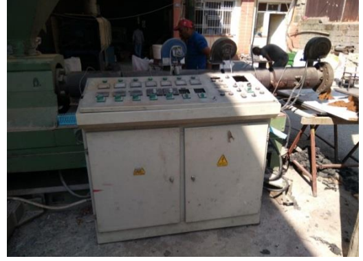
Şekil 3.18 : Çift vidalı ekstruder ve kumanda paneli [Foto; Ongan, 2019].
