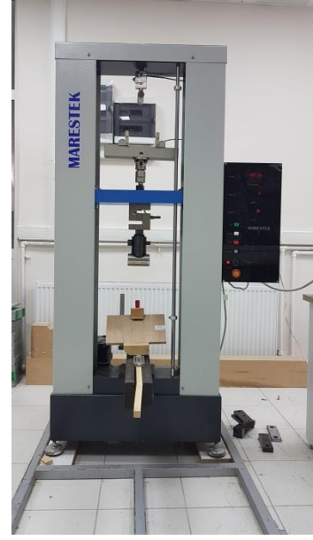
Şekil 3.35 : Diyagonal çekme deney düzeneğinde yük uygulama biçimi [Çizim ve foto; Ongan, 2019].
