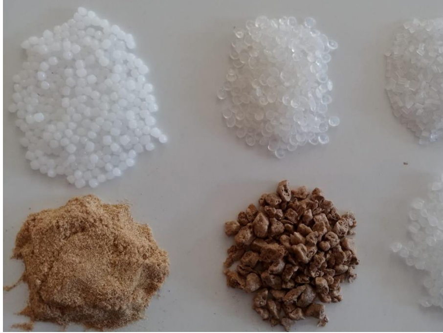
Şekil 1.1 : OPK üretiminde kullanılan materyaller ile bunlardan elde edilen pelletler [Foto; Ongan, 2019].
