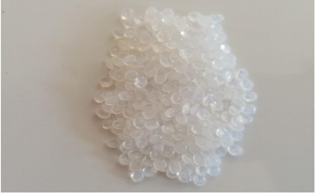
Şekil 3.4 : MAPE Maleik anhidrit graflanmış polietilen.
