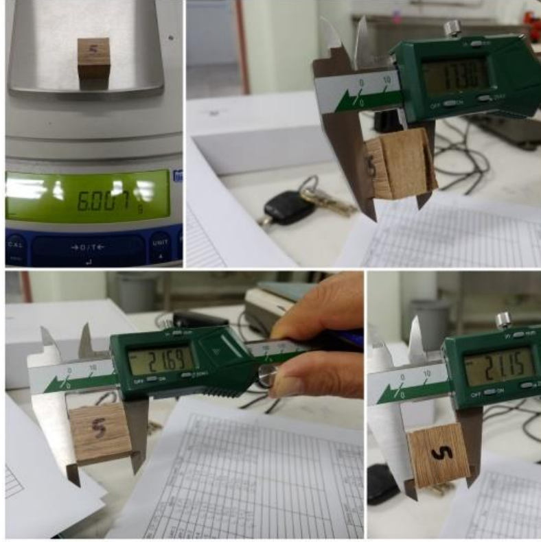
Şekil 3.23 : 72 saat sonra etüvden alınan 5 no'lu parçanın boyut ölçülerindeki değişimler ve ağırlık değerleri [Foto; Ongan, 2019].
