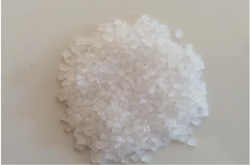
Şekil 3.5 : MAPP Maleik anhidrit graflanmış polipropilen.
