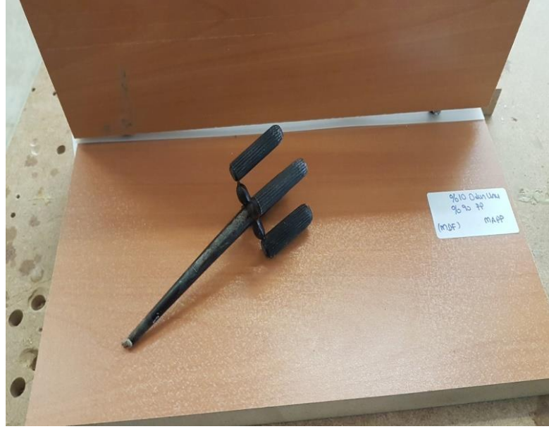
Şekil 3.6 : L-tipi köşe birleştirme deney örneği [Foto; Ongan, 2019].
