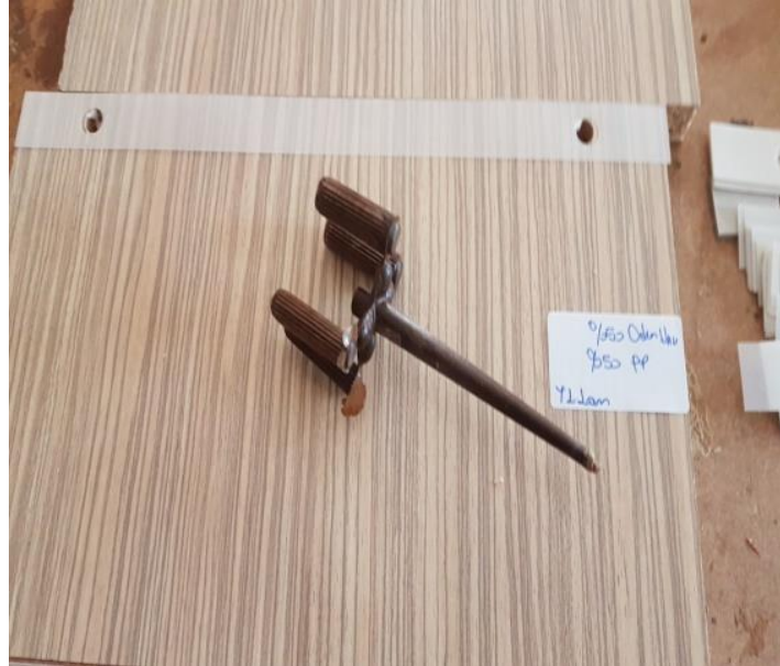
Şekil 3.7: L-tipi köşe birleştirme deney örneği [Foto; Ongan, 2019].
