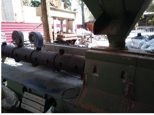
Şekil 3.18 : Çift vidalı ekstruder ve kumanda paneli [Foto; Ongan, 2019].
