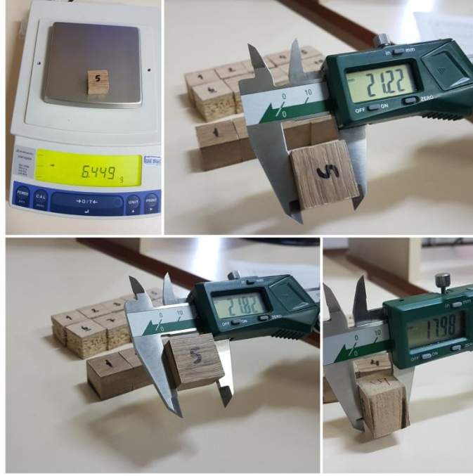
Şekil 3.22 : 5 no'lu Lif levha lam rutubetli ölçümleri [Foto; Ongan, 2019].
