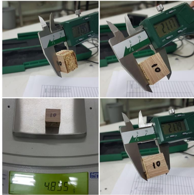
Şekil 3.21 : 10 no'lu Yonga levha lam rutubetli ölçümleri [Foto; Ongan, 2019].
