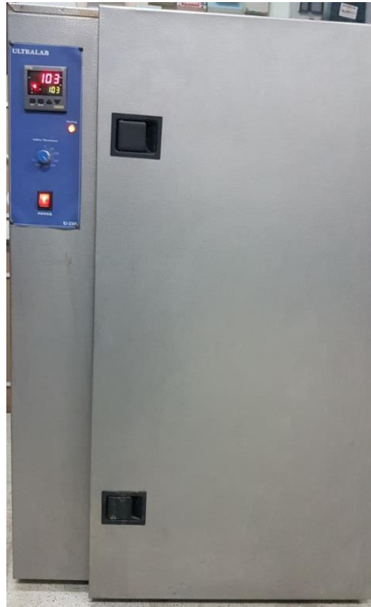
Şekil 3.25 : Kurutmada kullanılan etüv sıcaklık değeri [Foto; Ongan, 2019].
