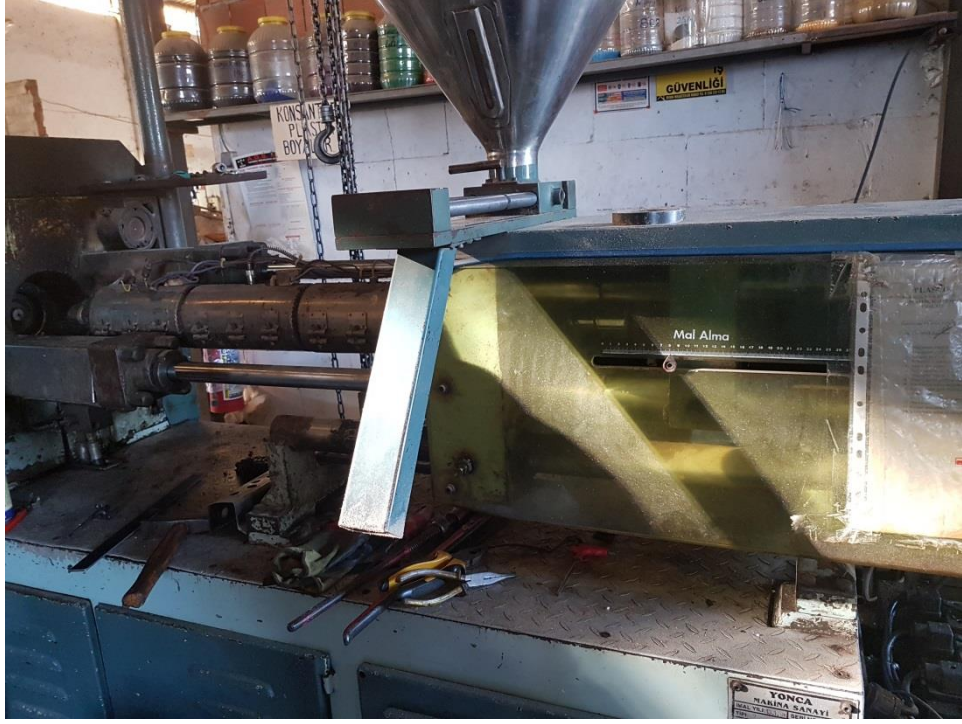
Şekil 3.15 : Üretimde kullanılan enjeksiyon kalıp makinesi [Foto; Ongan, 2019].
