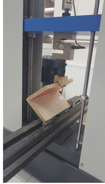
Şekil 3.33 : Diyagonal basınç düzeneği ve yük uygulama biçimi [Çizim ve foto; Ongan, 2019].
