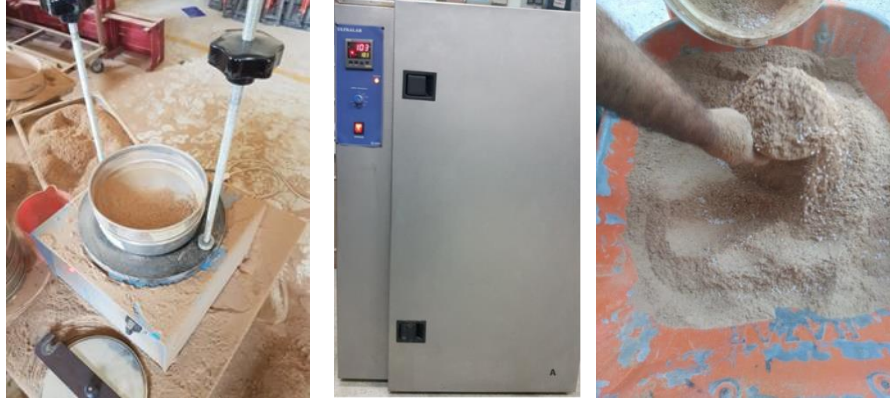
Şekil 3.17 : Sarsak elekten alınan odun unu \pm 103^{\circ}\text{C} de etüvde 24 saat bekletildikten sonra PE ve PP ile karıştırılmıştır [Foto; Ongan, 2019].
