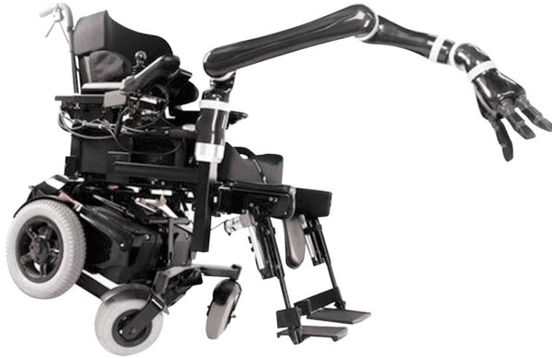
Şekil 1.5 : JACO robotik kol ile desteklenmiş bir akıllı tekerlekli sandalye örneği.
