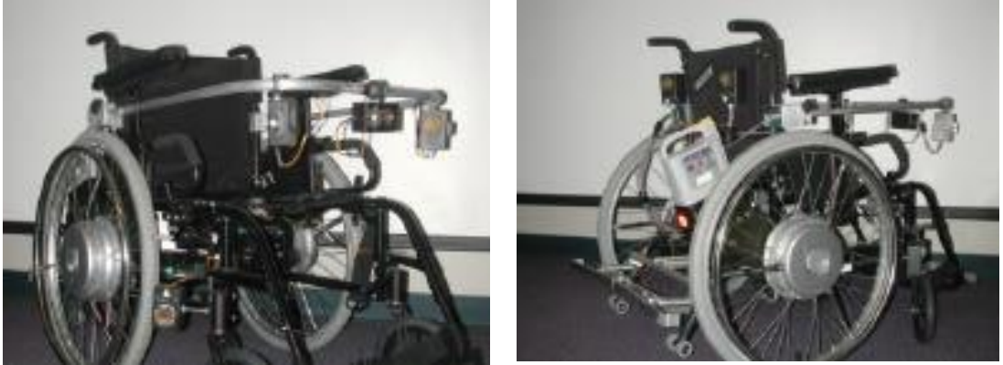
Şekil 1.7 : Manuel bir akıllı tekerlekli sandalye için Smart Powered Assistance Module (SPAM) modülü.
