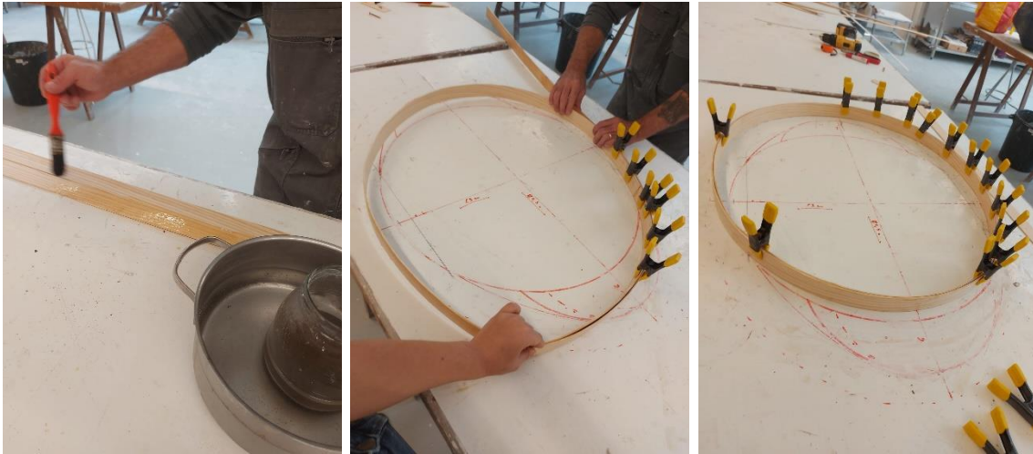
Figura 35 - Conjunto de imagens do processo produtivo do molde circular em madeira.
