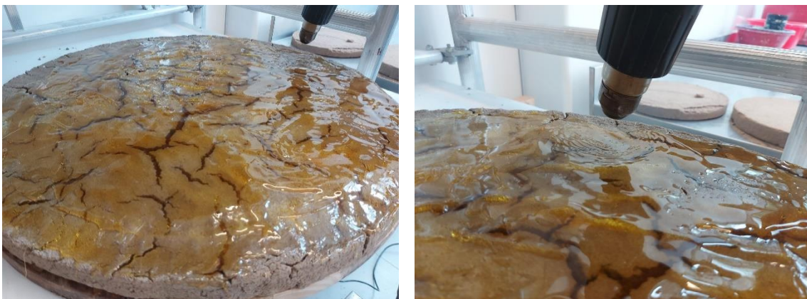
Figura 70 - conjunto de imagens do processo de preparação e aplicação da resina de pinheiro.
