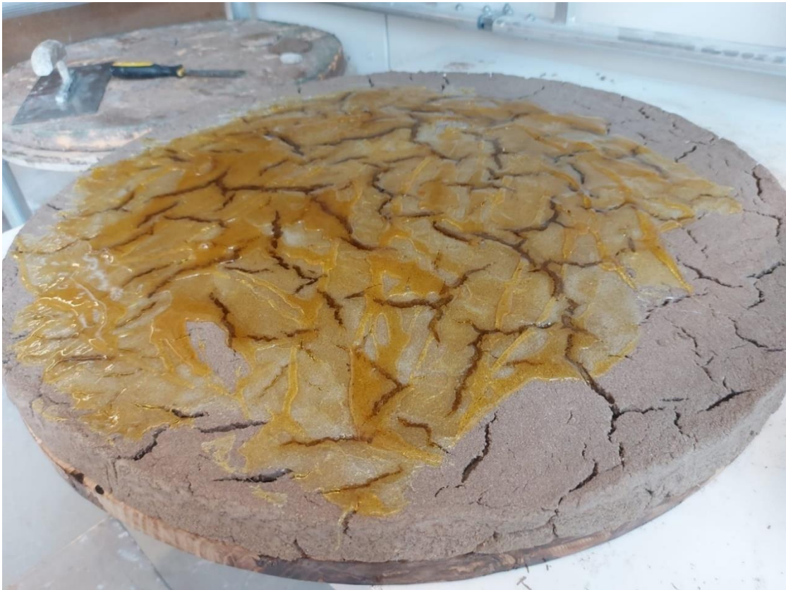
Figura 69 - imagem do processo de preparação e aplicação da resina de pinheiro.
