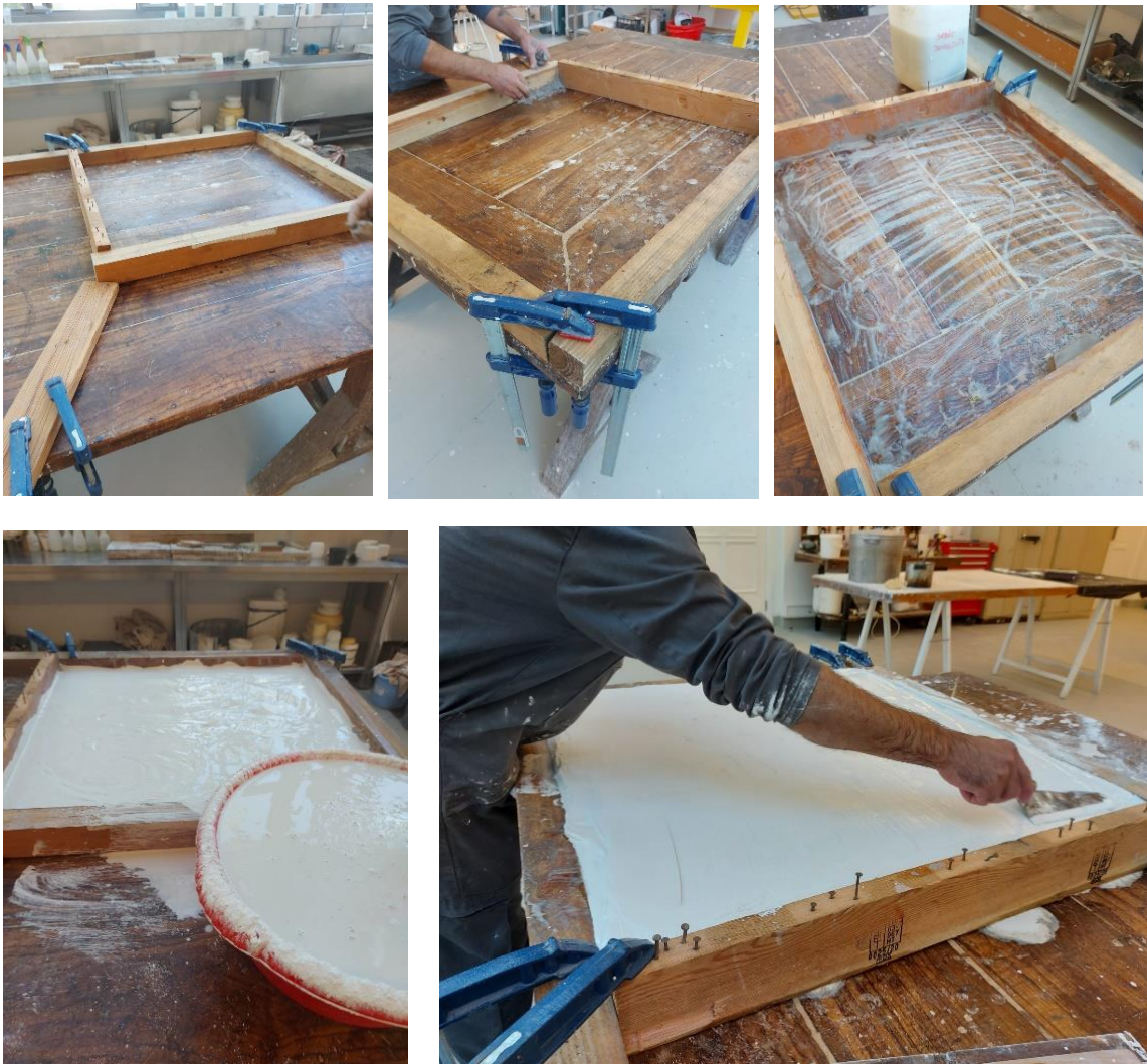
Figura 54 - conjunto de imagens do processo de produção do suporte em gesso.
