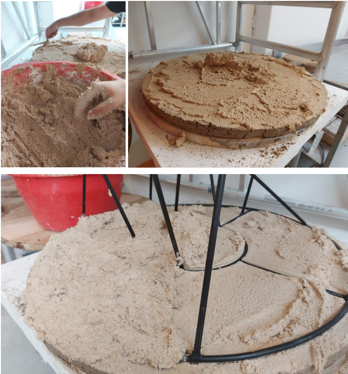
Figura 90 - conjunto de imagens do processo de colocação da estrutura e produção da peça final, mesa de centro.
